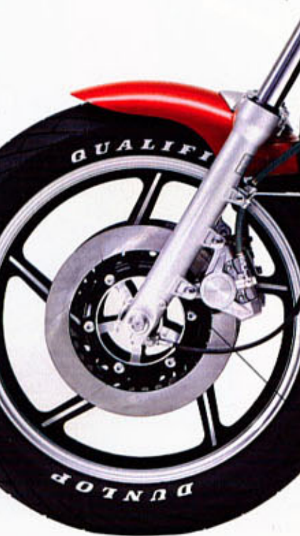
A l'avant, la puissance de freinage est confiée à deux disques ventilés de 282 mm de diamètre, équipés d'étriers à pistons opposés, et de plaquettes "tous temps" semi-métalliques.
